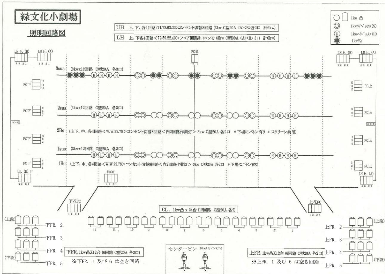
天井音響反射板(天反)ダウンライト回路↔第2サスペンションライト回路 切替説明図
